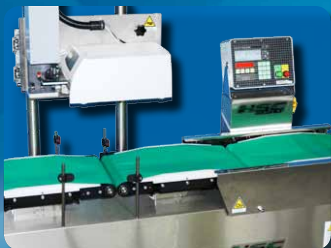
Transport pour produits cylindriques avec étiquetage par dessus
