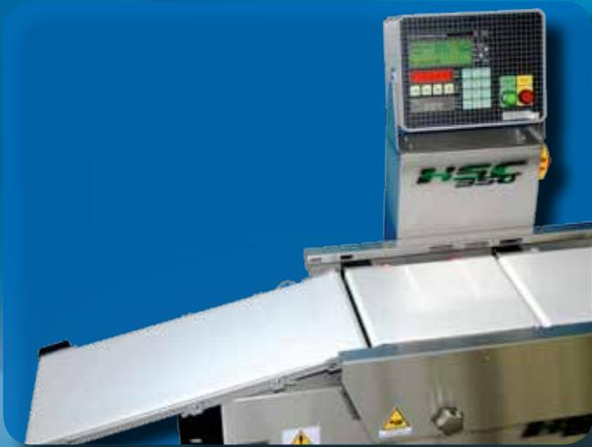
*Espulsore a nastro basculante*
