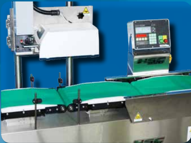
Transportband für Zylinderförmige Produkte mit Etikettapplikation oben
